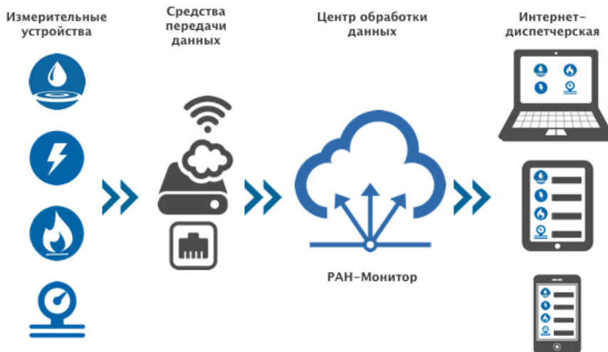
рис. 15 Принцип работы системы "ИИС Ран-Монитор"
