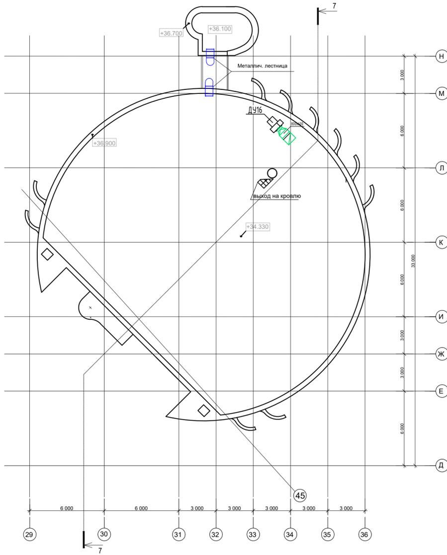
План машинного отделения на отм. +33.280м
