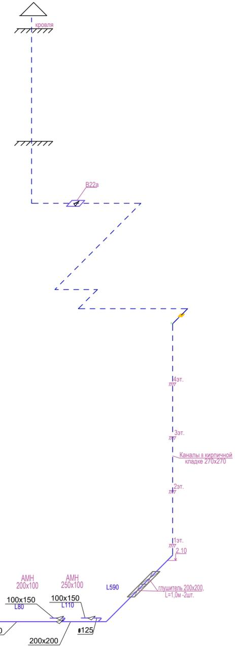
Схемы установки огнезадерживающих клапанов.
