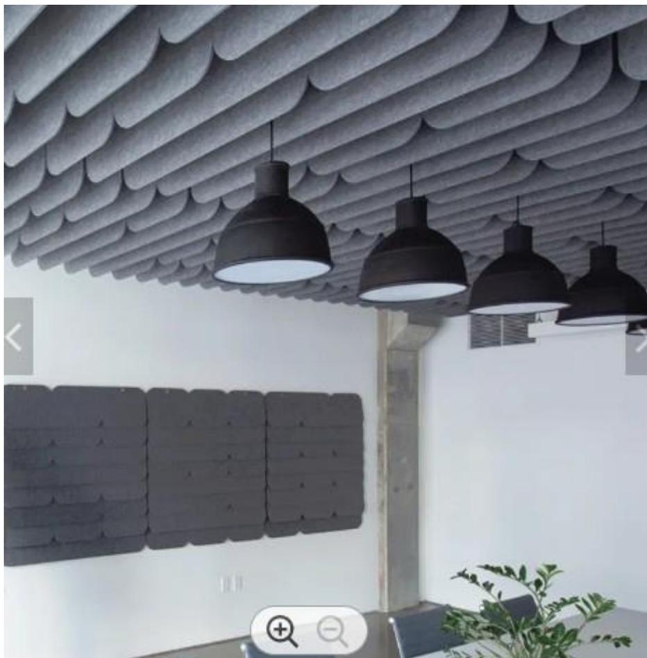
Дополнительными средствами снижения производственного и бытового шума являются звуковые диффузоры, потолочные акустические панели, акустическая потолочная плитка. Данные средства пассивной борьбы с шумом в настоящее время широко используются в оформлении офисов в виде декоративных панно, подвесных потолков, настенных инсталляций, покрытий пола.
