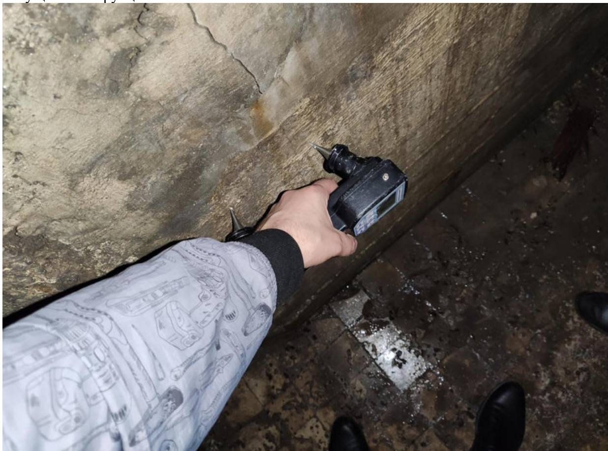
Фото №56. Испытание прочности бетона стены в вентиляционном помещении. Намокание несущих конструкций.
