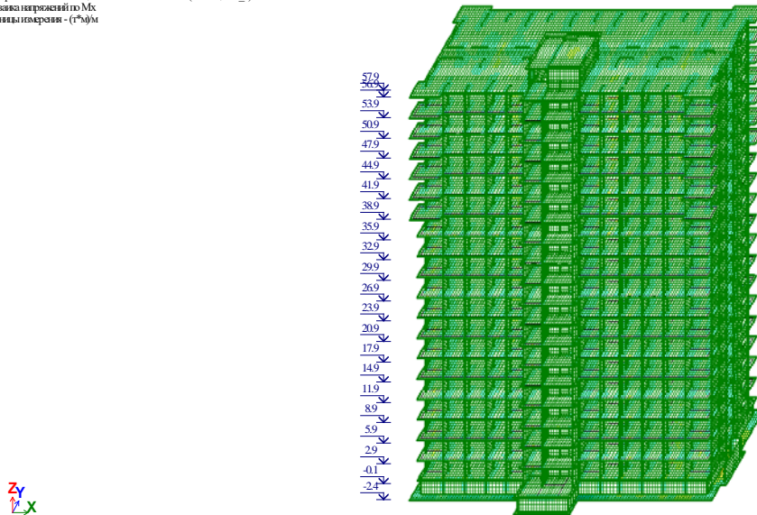
Рисунок 40. Мозаика напряжений Мх, (т*м)/м
