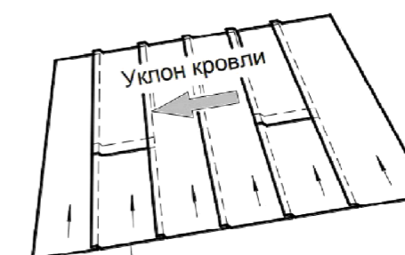
Направление укладки материала
