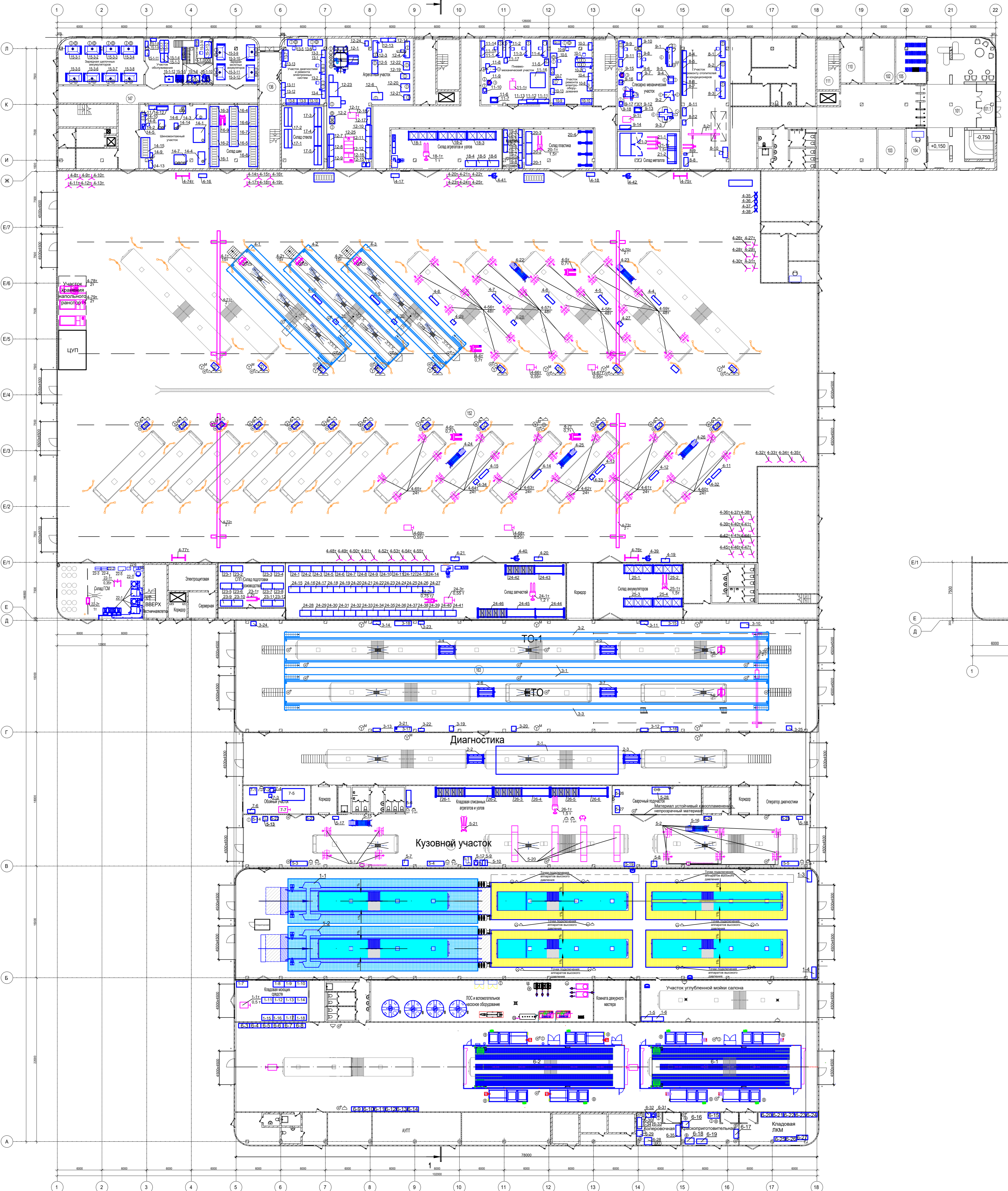
План расположения оборудования на отм. +4,200 между осями 'К-Л', '4-5'
