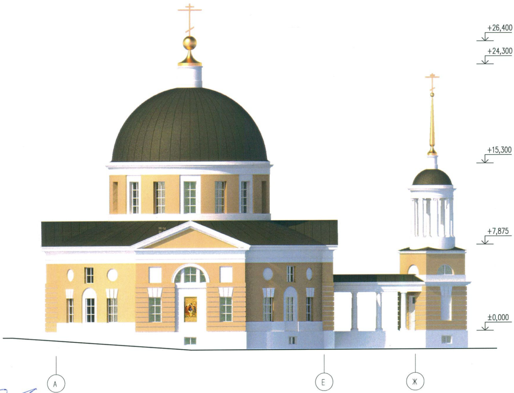
Храм. Схема фасада в осях А-Ж (на основе М 1:200)
