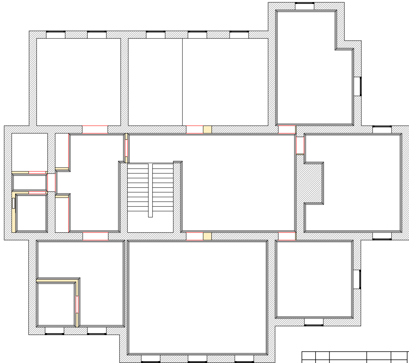
План размещения потолочных карнизов (лепнины)
