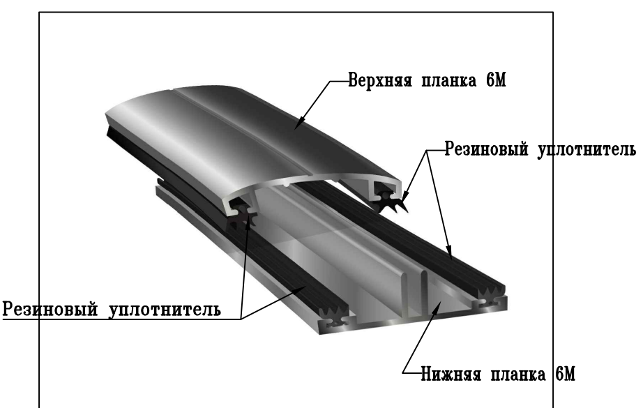
Алюминиевый профиль для крепления монолитного поликарбоната Общий вид
