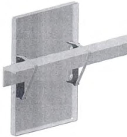
Рисунок 9 Крепление знака бандажной лентой на горизонтальный уголок. Адаптер на одну ленту
