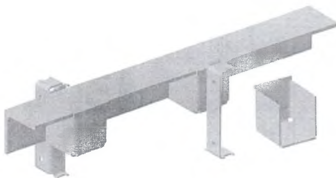
Рисунок 13. Вкладыш фиксации адаптера на полке уголка
