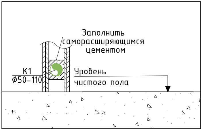
Узел прохода трубы в стене
