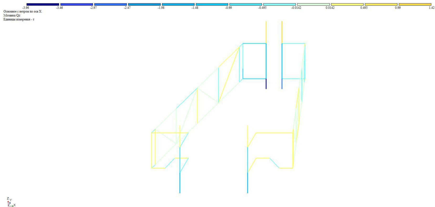
Рис. 58. Поперечная сила Q_z в элементах фермы для крепления рекламных щитов
