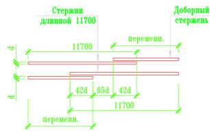
Деталь арм. торца плиты перекрытия
