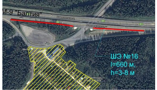
Рисунок 5.1.2 – Необоснованные разрывы в ШЭ
