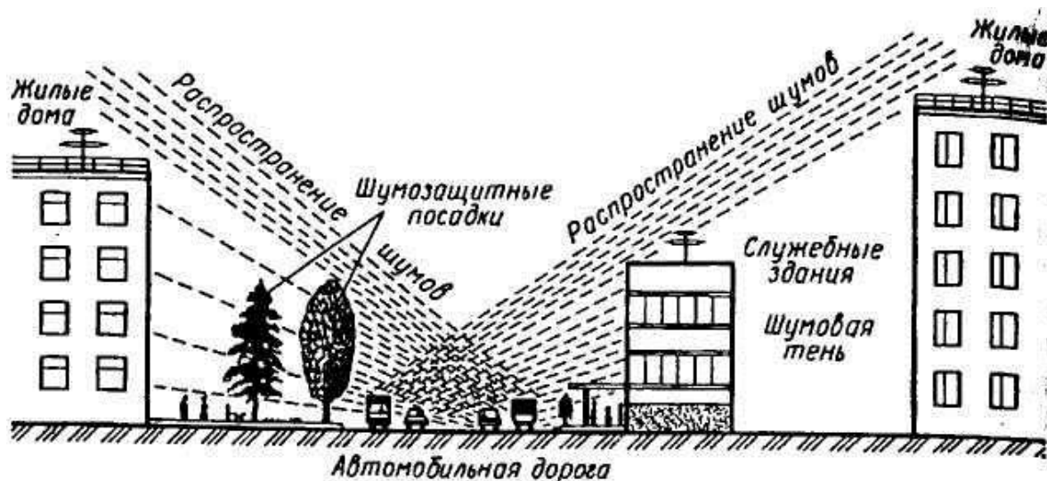
Рисунок 2.3.1 – Схема распространения уличного шума
