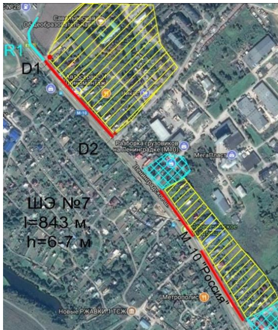
Рисунок 5.1.2 – Необоснованные разрывы в ШЭ
