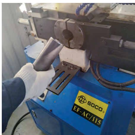
3. Снятие фаски и торцовка
