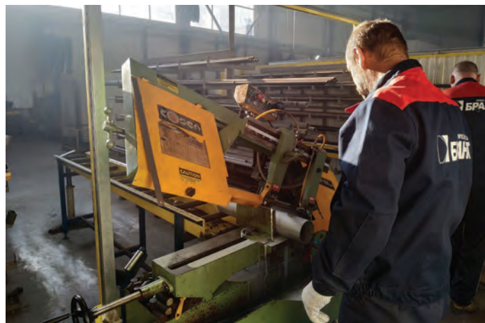
2. Распил трубы на полуавтоматических станках
