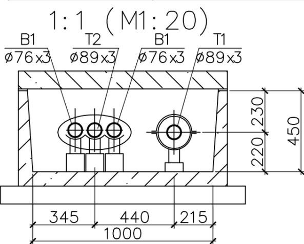
Деталь устройства герметичной перегородки на вводе труб тепловых сетей в здание
