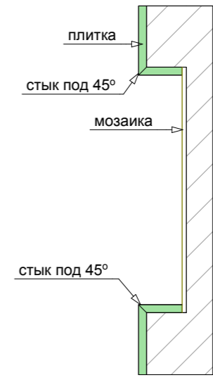
Раскладка плитки в нише
