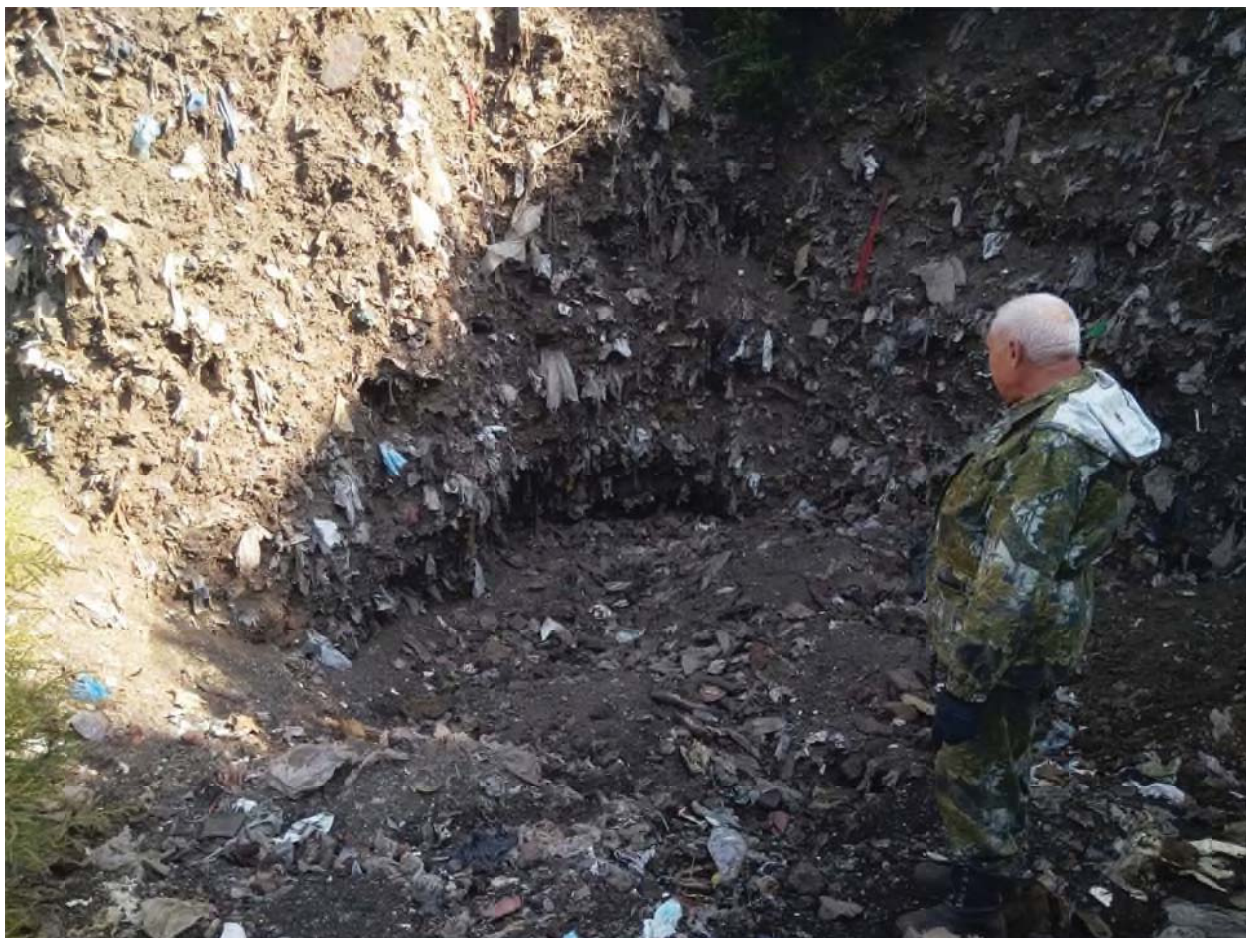
Фото 2. Состав и мощность (до 5,0 м) свалочных отложений близ точки наблюдений 5.
