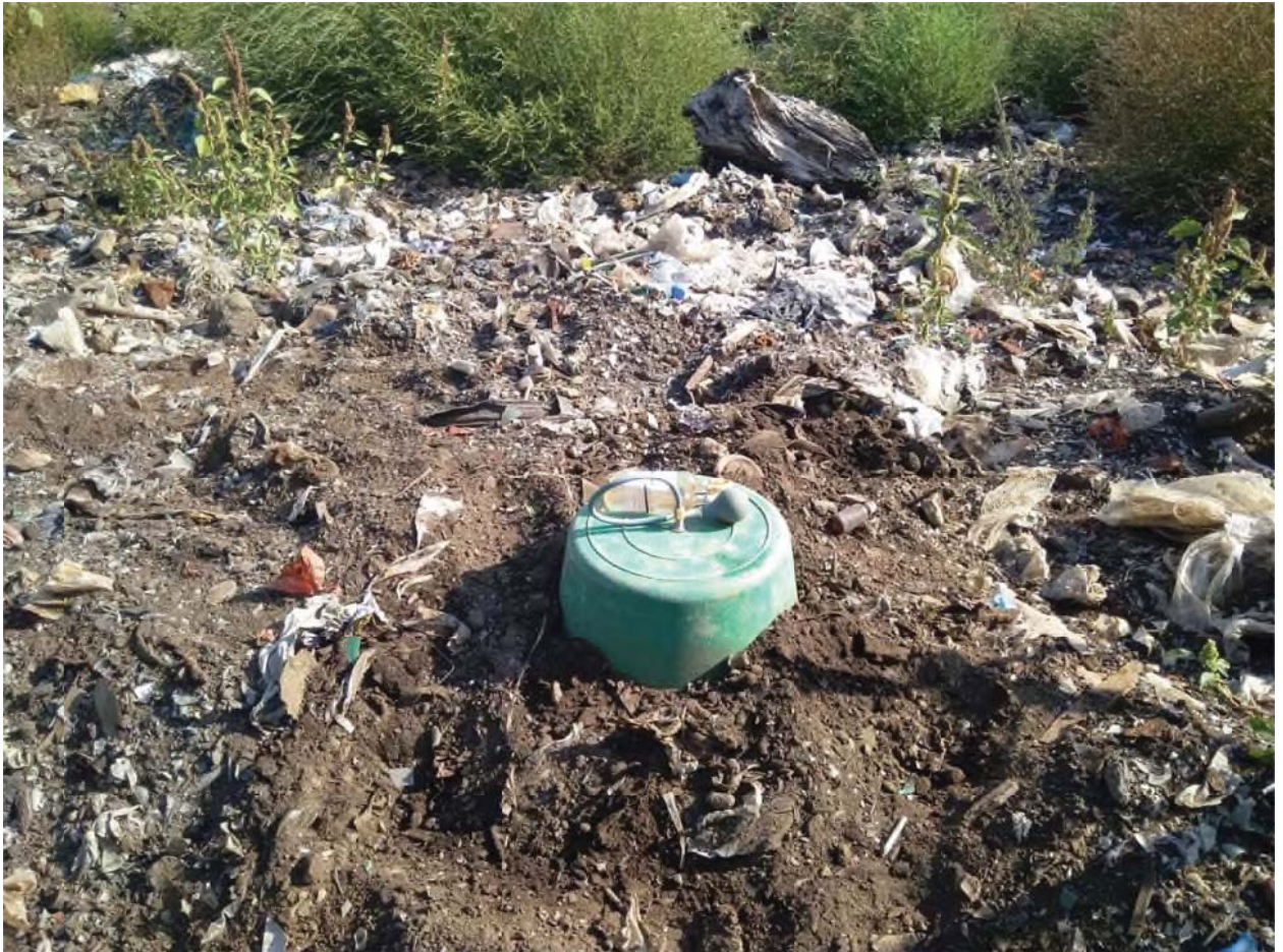
Фото 3. Измерение эмиссии биогаза с поверхности свалки.
