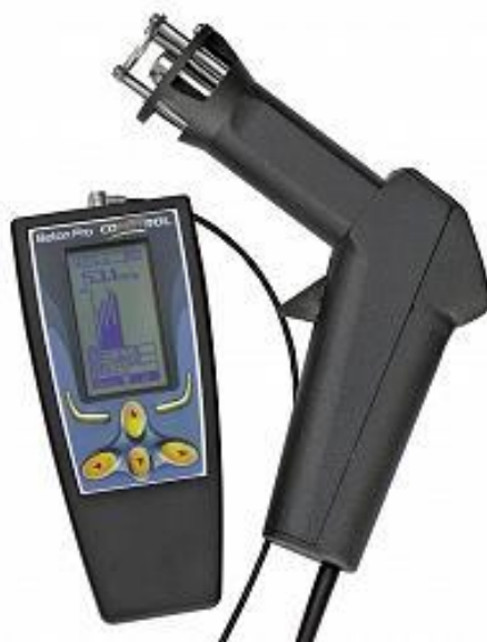
Рис. 5.1. Прибор для измерения прочностных характеристик строительных материалов «Beton Pro CONDROL».
