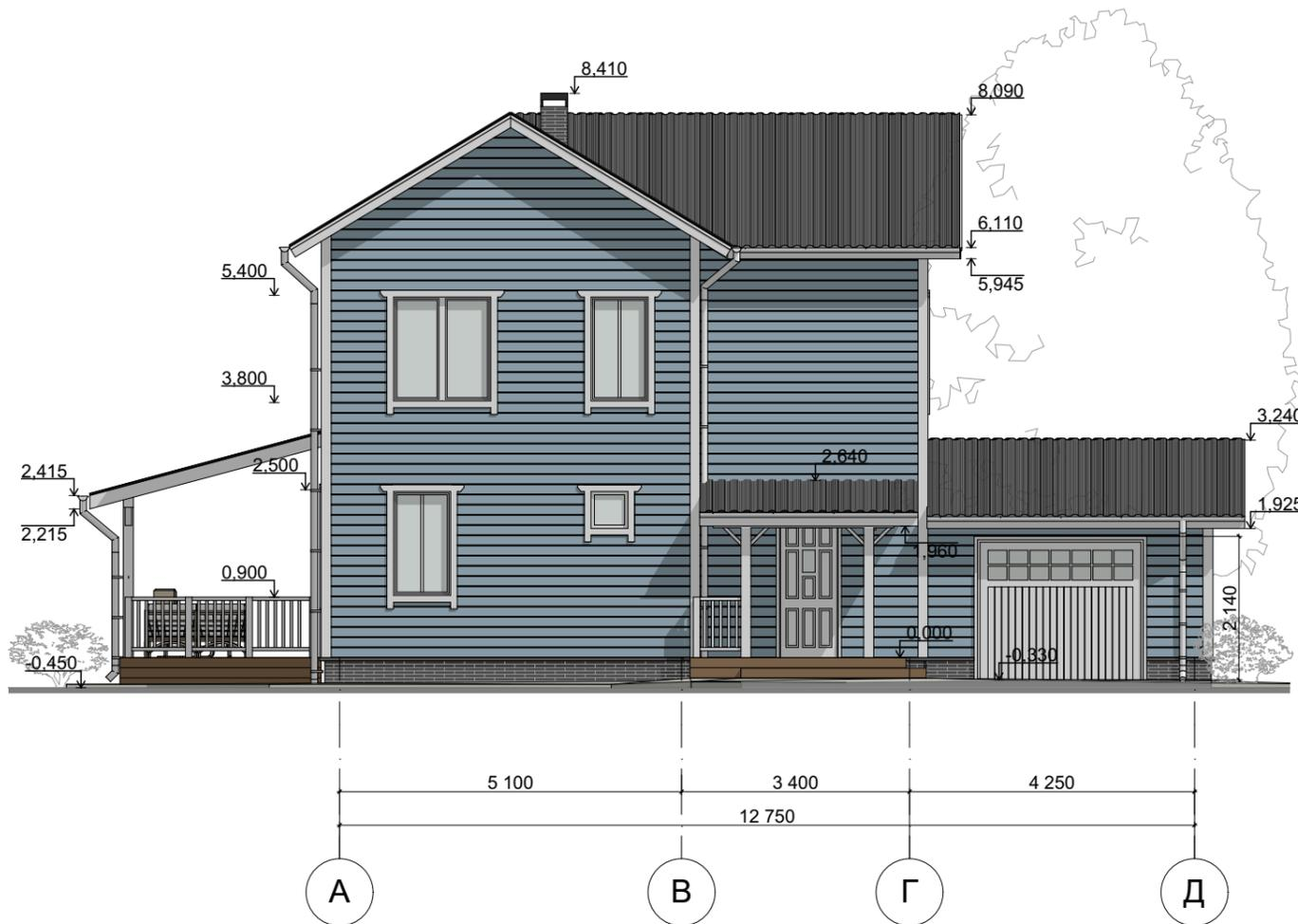
Фасад в осях 3-2-1 М 1:100
