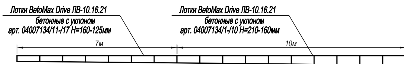
Каскад 2 - Лотки BetoMax Drive DN100 L=17м
