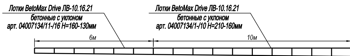
Каскад 1 - Лотки BetoMax Drive DN100 L=16м
