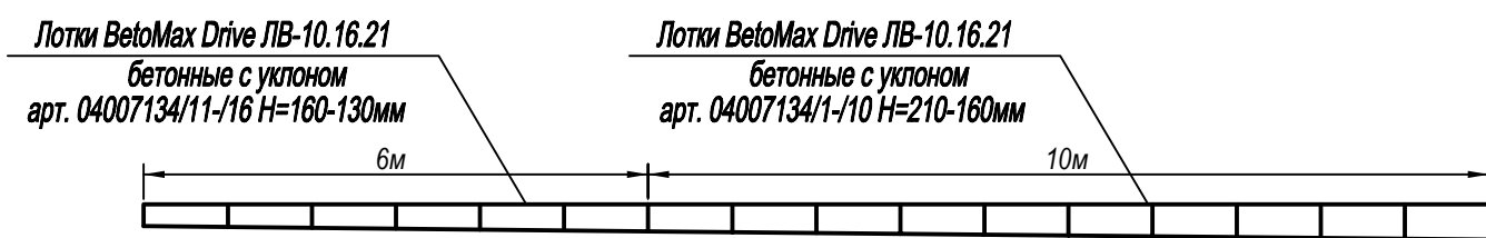
Каскад 5 - Лотки BetoMax Drive DN100 L=16м
