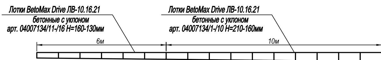
Каскад 6 - Лотки BetoMax Drive DN100 L=16м
