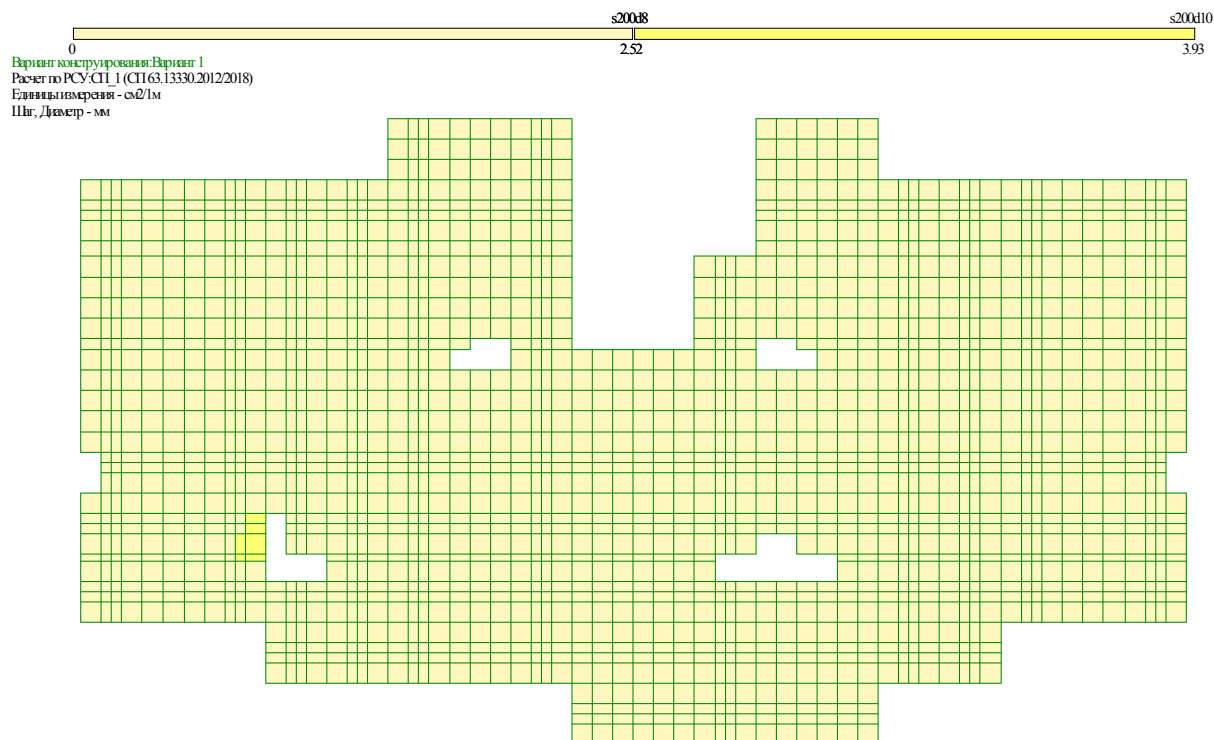
Рис. 2.113 Площадь полной арматуры на 1м по оси Y у нижней грани (балки-стенки - посередине)
