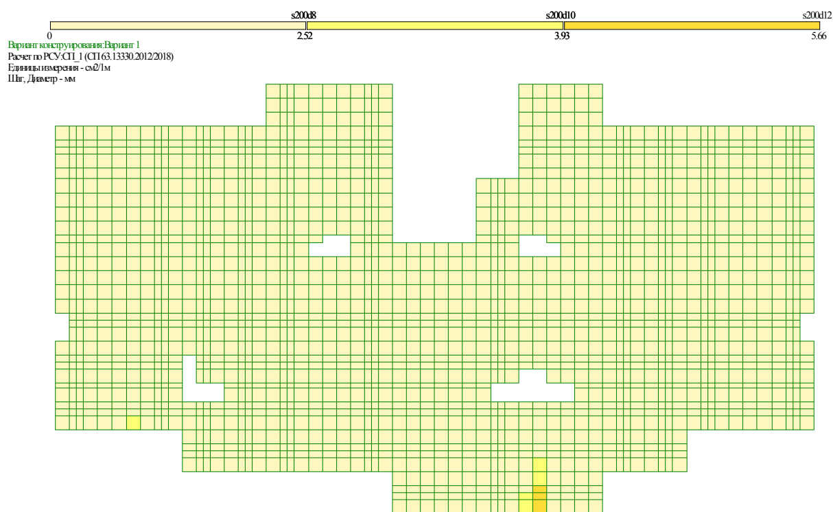
Рис. 2.111 Площадь полной арматуры на 1м по оси Y у верхней грани
