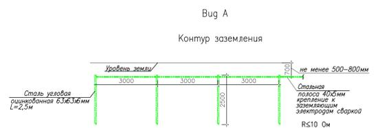
Схема системы дополнительного выравнивания потенциалов
