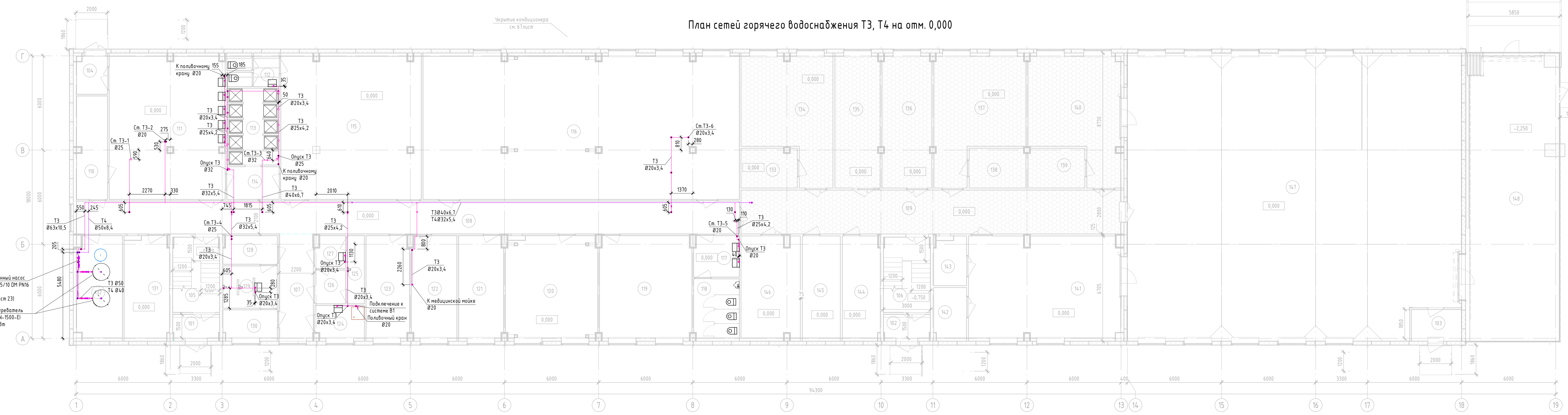
План сетей горячего водоснабжения Т3 на отм. 3,900
