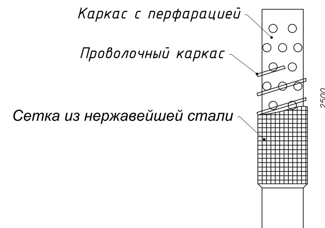
Фильтр водозаборной камеры
