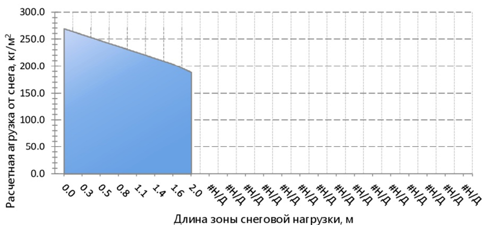
График интенсивности снеговой нагрузки (расчетное значение)
