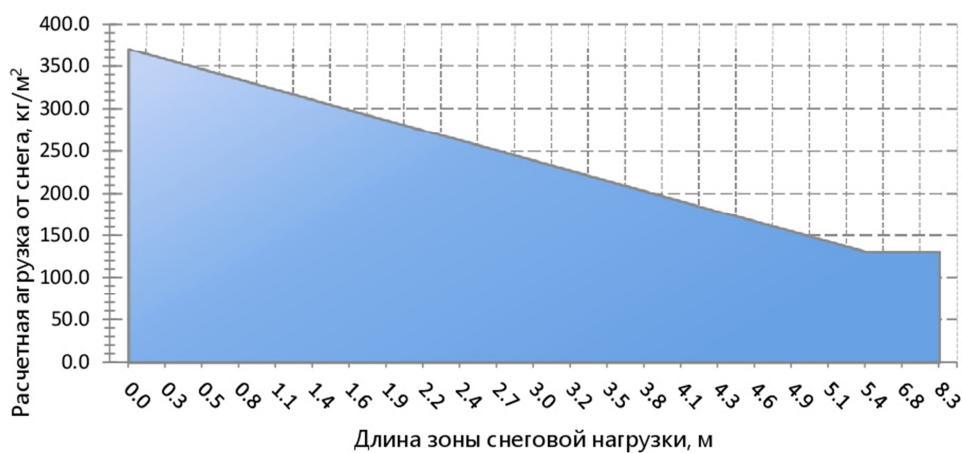
График интенсивности снеговой нагрузки (расчетное значение)
