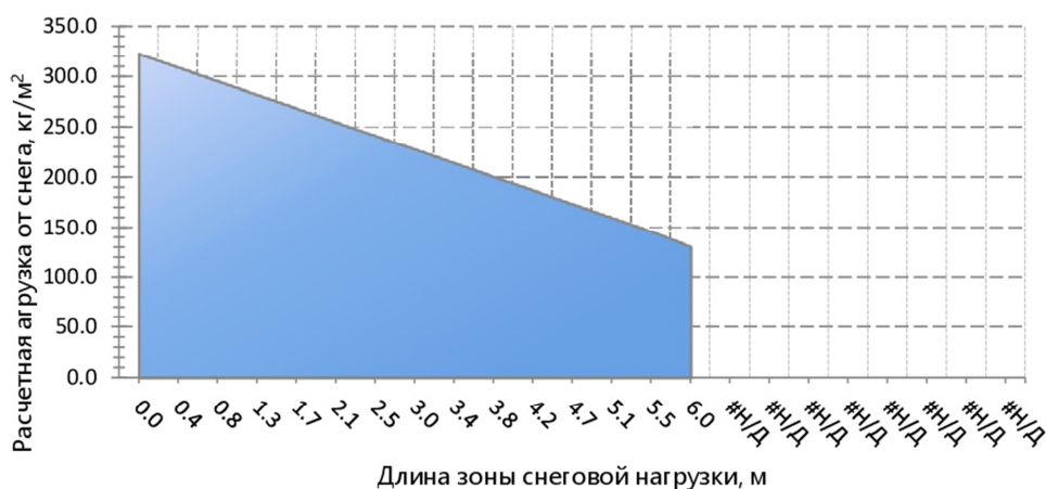
График интенсивности снеговой нагрузки (расчетное значение)
