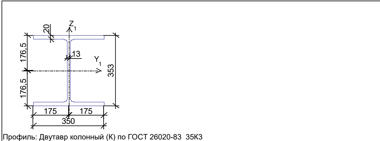
Профиль: Двутавр колонный (К) по ГОСТ 26020-83 35К3
