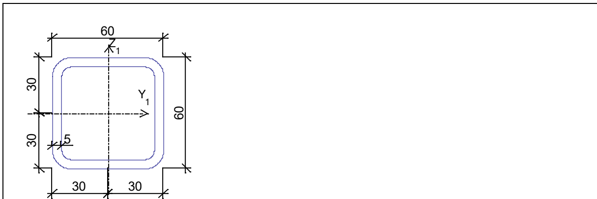
Профиль: Стальные гнутые замкнутые сварные квадратные профили по ГОСТ 30245-2012 60x5
