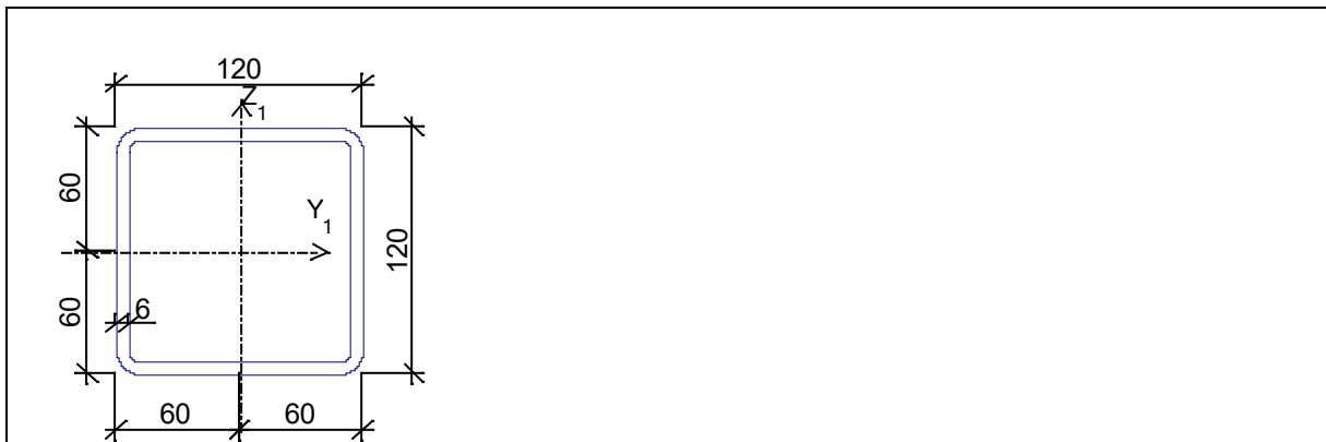
Профиль: Стальные гнутые замкнутые сварные квадратные профили по ГОСТ 30245-2003 120x6
