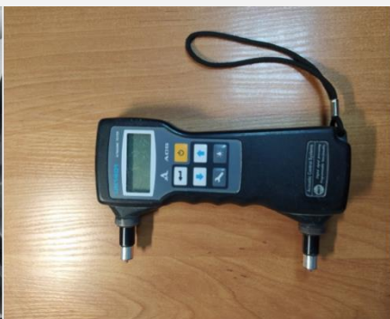
Прибор УК 1401 – прочность бетона ультразвуковым методом
