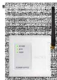
Подключение до 32 радиоканальных устройств
