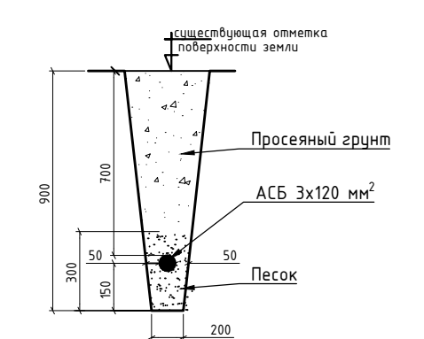
Прокладка КЛ-6 кВ в земле
