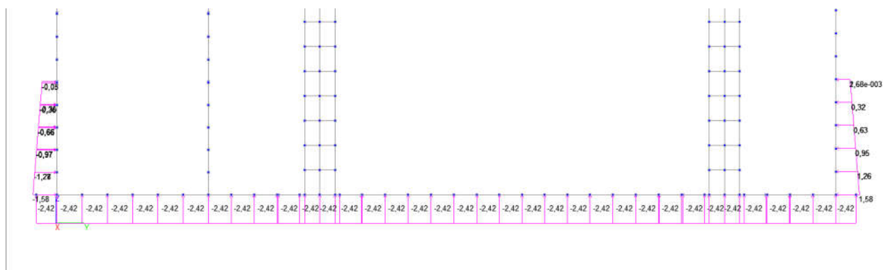
Рис. 4.17 Пример схемы приложения нагрузки L38 «Давление грунтовых вод»
