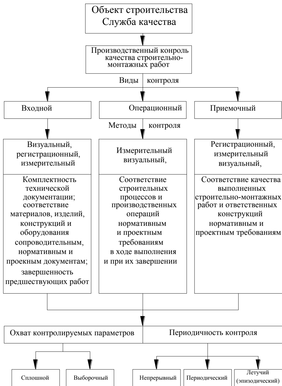
Рис. 1. Общая схема производственного контроля качества строительно-монтажных работ.
