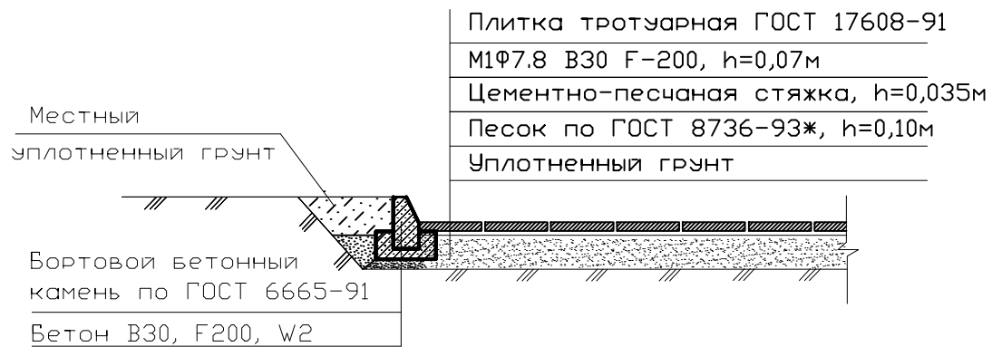
Сечение проект. плиточного покрытия (тип 2)
