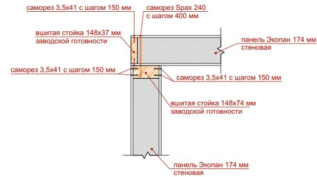
Условная схема вертикальных узлов
