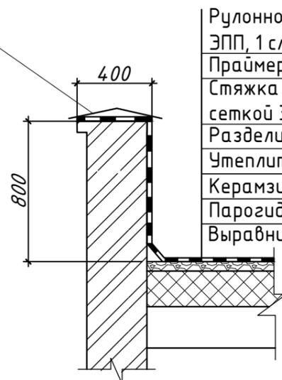
Рулонное покрытие (1 слой - Техноэласт ЭПП, 1 слой - Техноэласт ЭКП)
