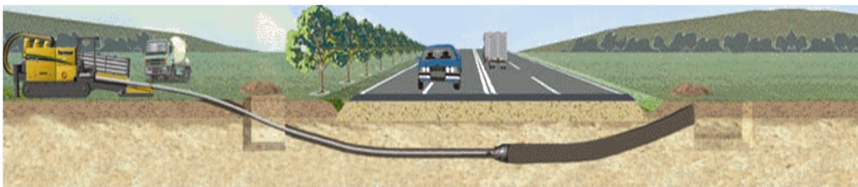
Рисунок 3.2. Расширение пилотной скважины
