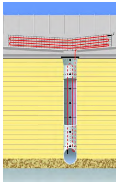
Рисунок 3.4. Обогрев свеса кровли
