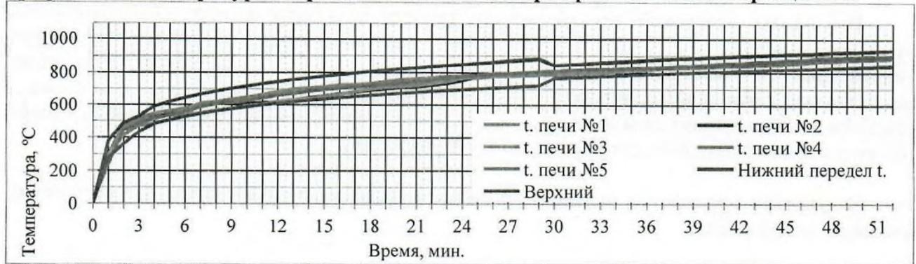
**График №2. Изменение температуры образца № 1 в процессе проведения испытаний.**
