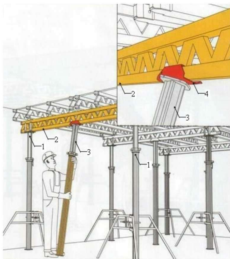
Рисунок 3.14. Установка промежуточных стоек: 1-основная стойка; 2 - продольная балка; 3-промежуточная стойка; 4-головка-захват
