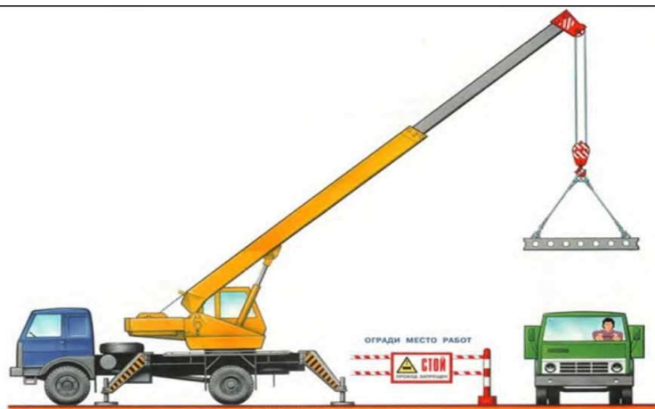
Рисунок 6.2. Схема установки автомобильного крана
