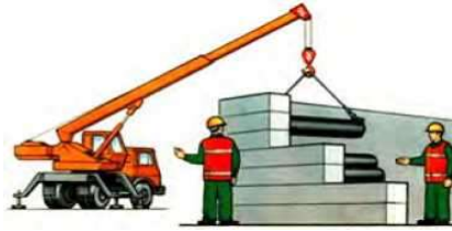
Рисунок 6.4. Передача сигналов в ограниченной зоне видимости
