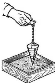
Рисунок 4.1. Проверка подвижности бетона эталонным конусом
