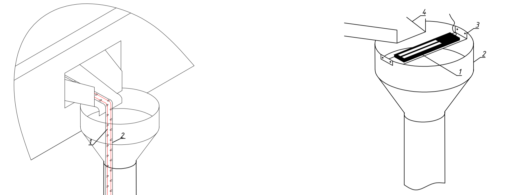
Электрообогрев выпусков с кровли с парапетом
