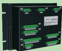
Микроконтроллерная защита присоединений секции сборных шин от замыканий на землю в сетях с изолированной нейтралью МКЗЗП-B3
