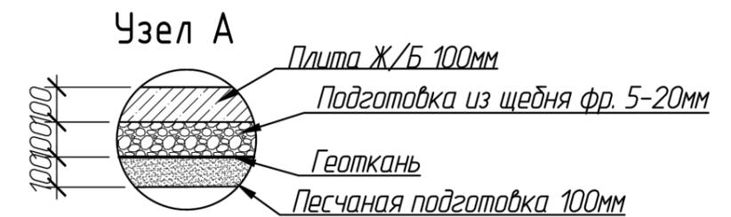
Бетонная плита армируется сеткой с шагом 50 x 50
