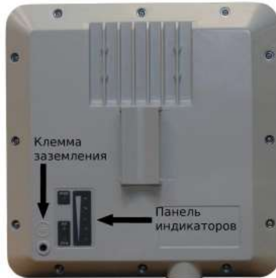
Рисунок 12.2 – Внешний модуль (ODU) абонентской станции SkyMan с антенной 19 дБ
