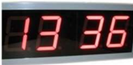
Рисунок 12.29 – Вторичные электронные табло-часы серии «Кварц-1» для помещений
