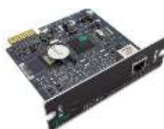
Рисунок 12.10 – Плата сетевого управления ИБП UPS Network Management Card 2
