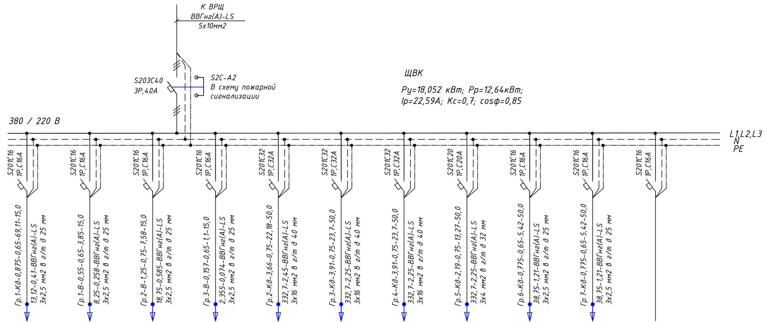
Маркировка-расч. нагрузка, кВт; коэффициент мощности - расчетный ток, А-длина участка, м
