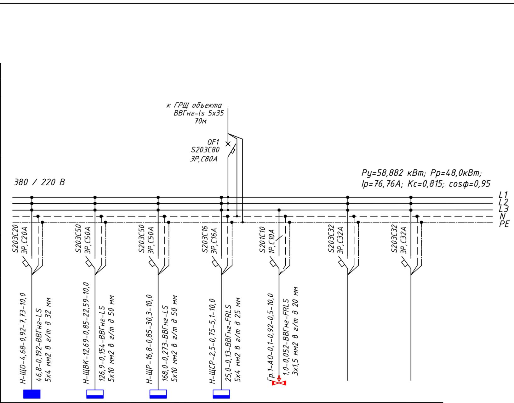
**Маркировка-расч. нагрузка, кВт; коэффициент мощности - расчетный ток, А-длина участка, м**
