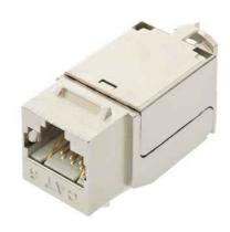
Коммутационные модули NIKOMAX системы Fast Termination. В процессе заделки модуль не повреждается и пригоден для многократной перезаделки в случае необходимости. IDC контакты модулей FT также совместимы с обычным ударным инструментом с ножом 110 типа или Krone.
