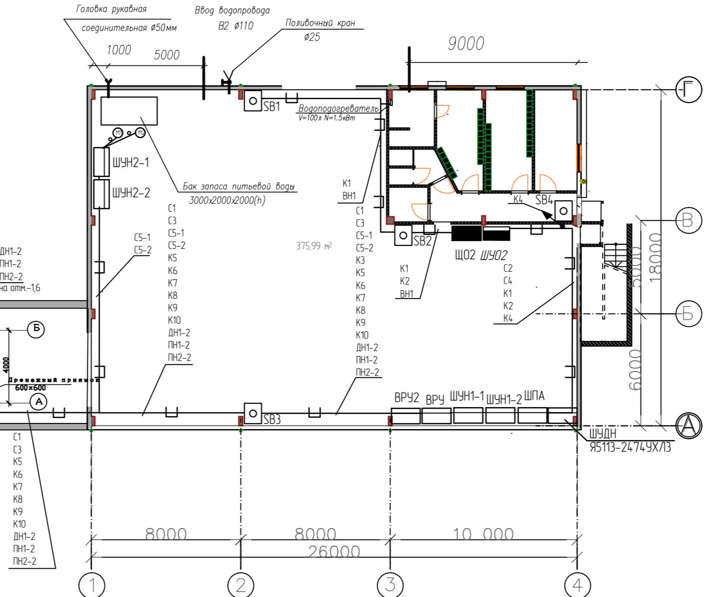
Сети проложить в лотках на высоте 4м от пола. Спуски к кнопкам, шиткам, электрооборудованию выполнить в ПВХ трубе ф20мм. Сети управления и питания противопожарных систем проложить в отдельном лотке.
