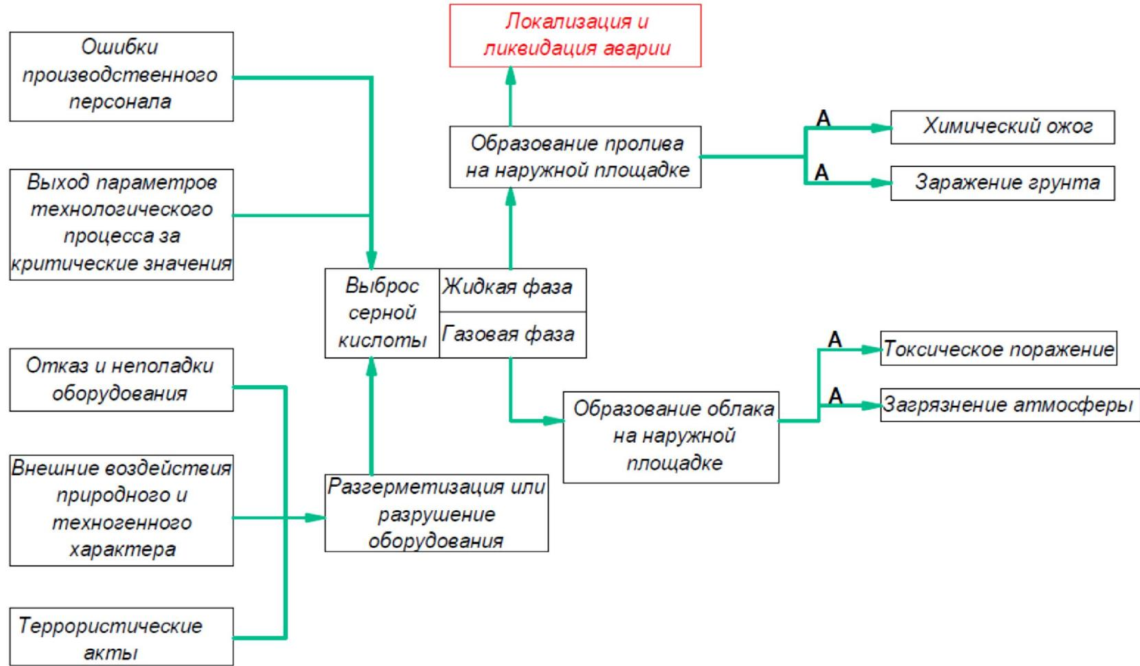
Рисунок 2.1. Схема развития аварийной ситуации по сценарию 1.1 (С1.1) - выброс серной кислоты на открытой площадке → наиболее вероятный сценарий развития аварийной ситуации
