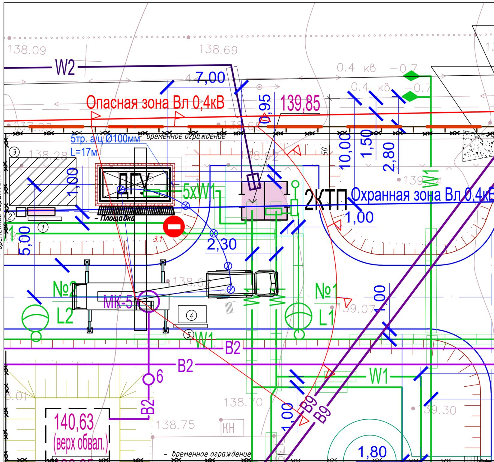
1. Проект организации строительства выполнен на монтаж дизельно-генераторной установки (ДГУ) АД-520С-Т400-2РМ17-2шт., 0,23/0,4кВ, 2х540кВт/2х650кВА в блок-контейнере УБК-12 Север - 1шт.
