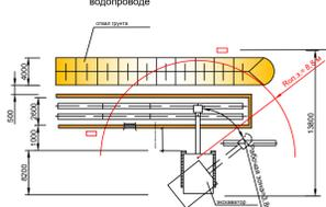
Укладка труб при помощи экскаватора, оснащенного щитом
